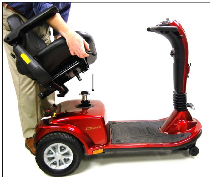
**FIGURE 24. REINSTALL THE SEAT**
