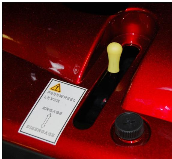
FIGURE 11. FREEWHEEL LEVER (ENGAGED)
