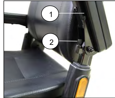
Imagen 9. Ajuste de ángulo del reposabrazos
