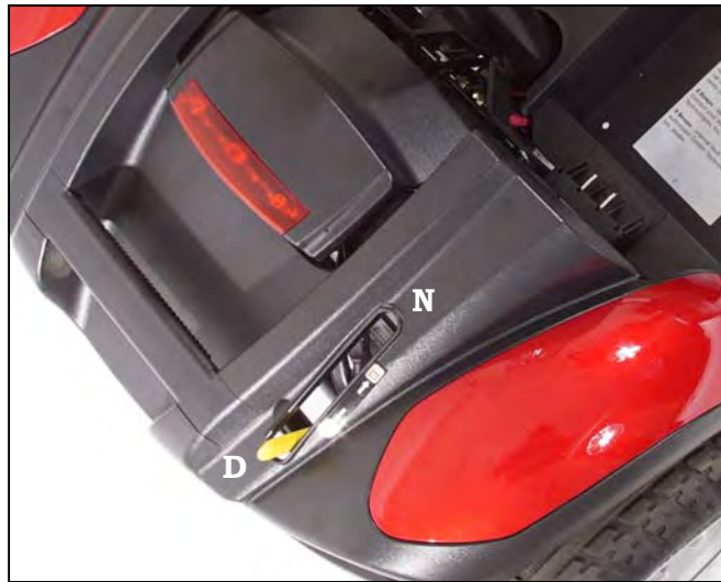
Imagen 13: Palanca rueda libre (En Drive)
