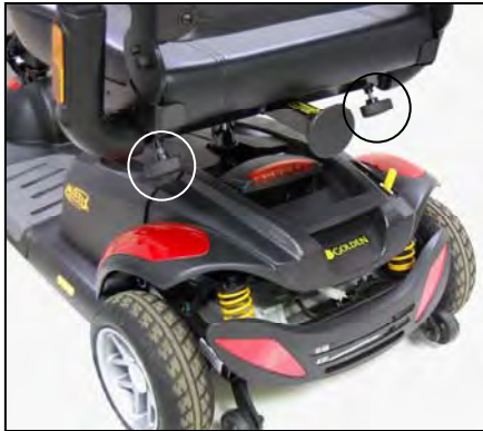
Imagen 8. Ajuste de anchura del reposabrazos
