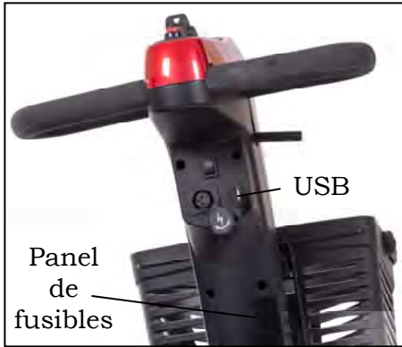
Imagen 6. Puerto de carga USB de 1 AMP
