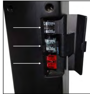
Imagen 7. Panel de fusibles
