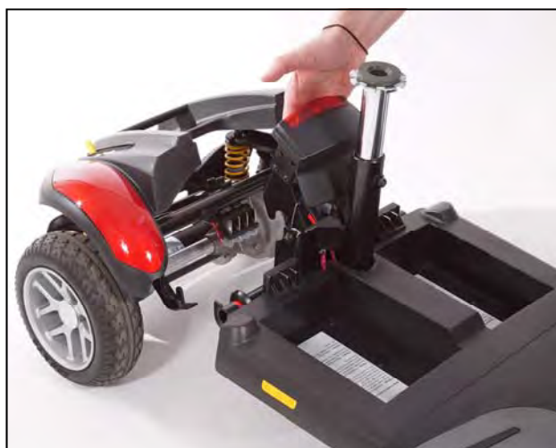
Imagen 19. Separando el tren de manejo y el armazón
