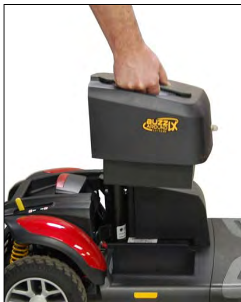
Imagen 23. Instalación de la batería
