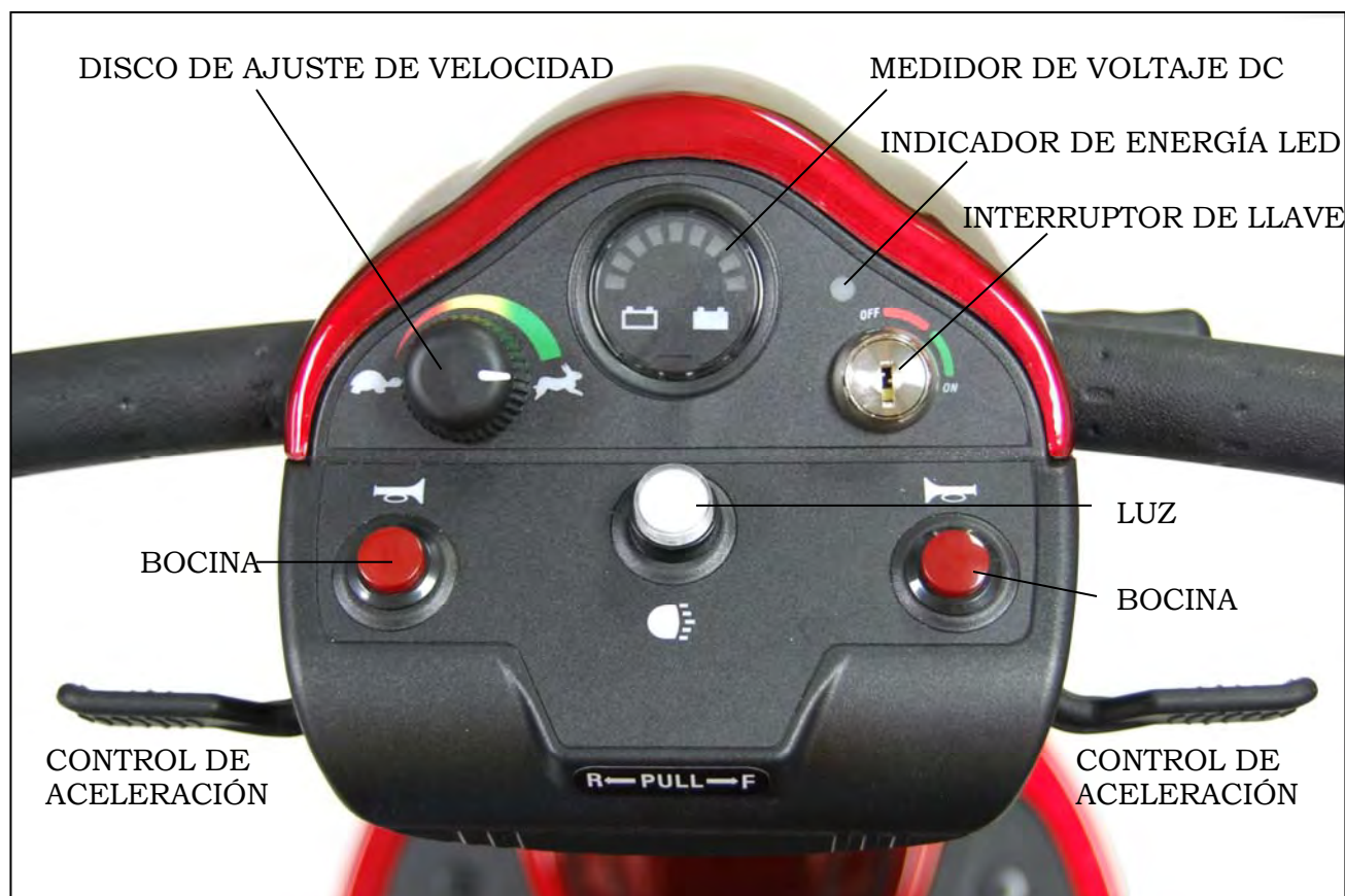
IMAGEN 5. PANEL DE CONTROL
