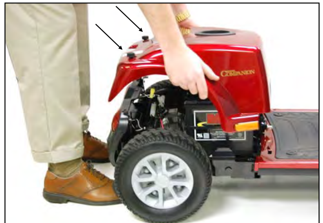
IMAGEN 16. REMOVIENDO LA CUBIERTA TRASERA
