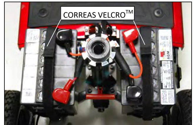
IMAGEN 17. REMOVIENDO LAS BATERÍAS
