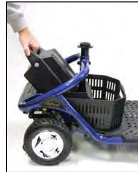
**Imagen 14. Removiendo la batería**
