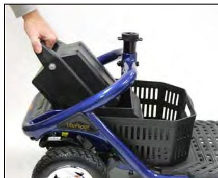
**Imagen 21. Instalación de la batería**
